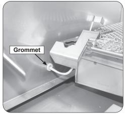
Fig. 5-2 Install grommet
